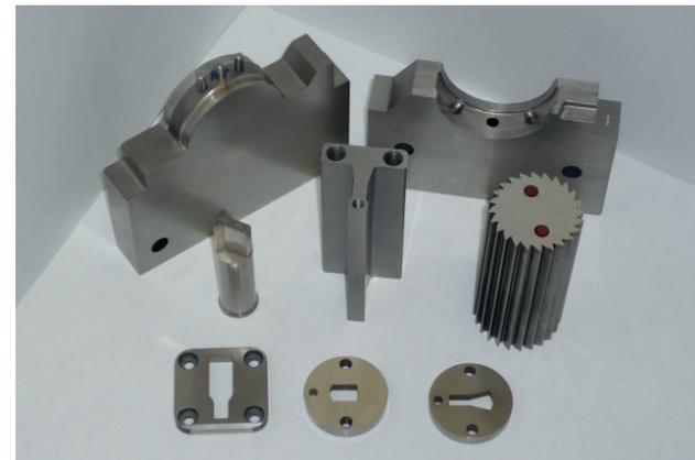
Biegevorrichtungen für Schellen Schnittstempel mit feiner Oberfläche, teilweise beschichtet, kleine Schnittmatrizen mit Konik (gefräst, geschliffen, senk- oder drahterodiert)
