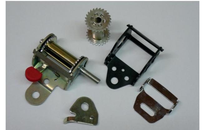
Automotive-Teile als Baugruppe oder Einzelteil Gehäuse und Klemm- u. Sicherungsteile, teilweise mit Prägungen und Verzahnungen, aus S355MC/S500MC, DD01/DD11, 42CrMo4 oder C45/C60, teilweise gehärtet, CrVI-frei verzinkt (blank oder schwarz) oder schwarz KTL-beschichtet
